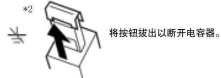
将按钮拔出以断开电容器。
